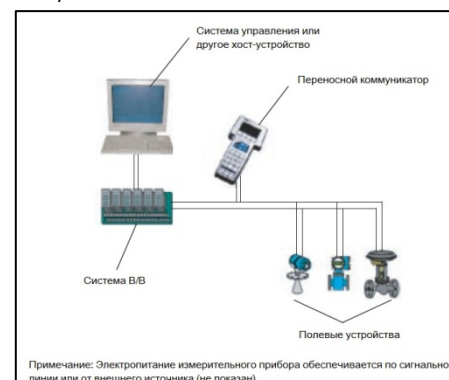
Рисунок 2. Типовая система HART (с разрешения HCF)
