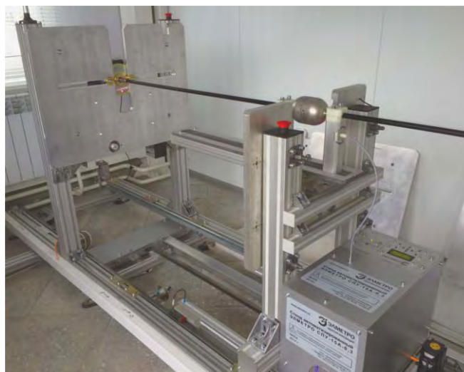
Рис. 17. Фрагмент стелды для поверки уровнемеров с установленным поплавковым уровнемером
