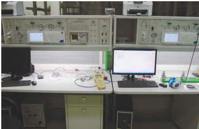
Рис. 4. Стенды поверки датчиков давления на базе контроллера DRUCK RАСЕ6000, поставленные в ОАО «Теплоприбор», г. Челябинск
