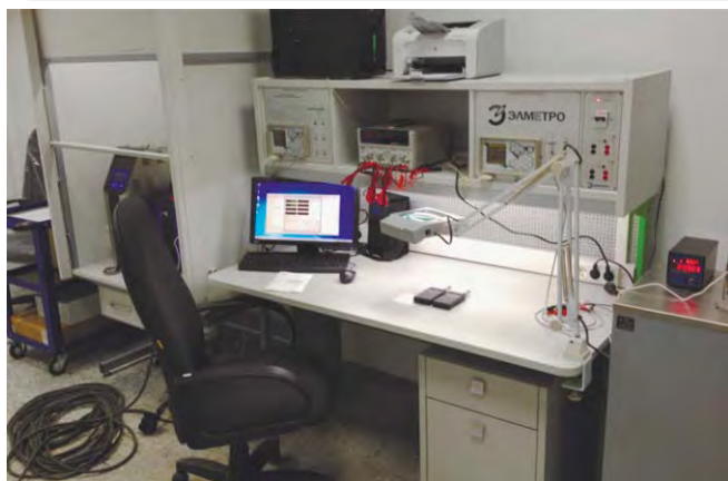
Рис. 12. Стенд поверки, калибровки и ремонта преобразователей температуры
