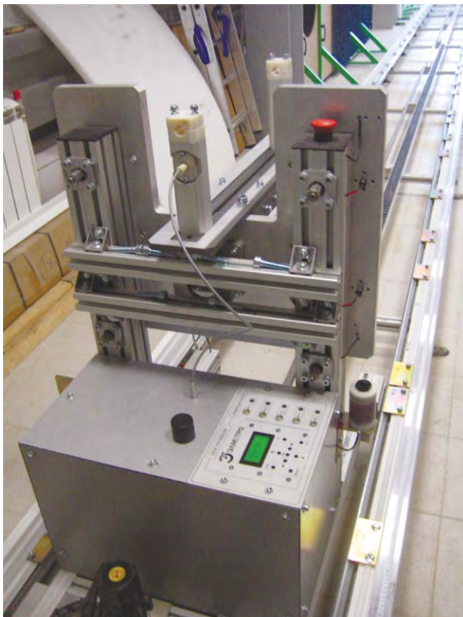
Рис. 15. Стенд поверки, калибровки и ремонта радарных, рефлекс-радарных, ультразвуковых, поплавковых и волноводных в т.ч. тросовых уровнемеров. Стенд сдан и запущен в промышленную эксплуатацию на ведущей нефтедобывающей компании в Западной Сибири
